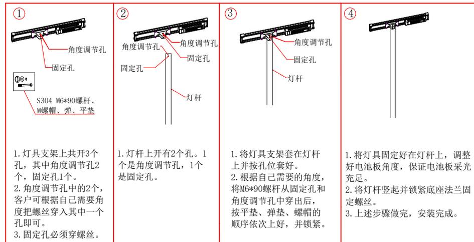
注意：使用前先将灯具在阳光下照射电池板激活启动光源板，或用随货的遥控器启动。待光源指示灯慢闪充电后，再去安装。
