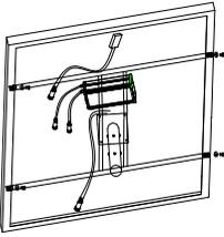
用螺杆将电池板及灯杆套头按位置固定在电池板支架上，依次平、弹垫、螺帽，然后锁紧。
