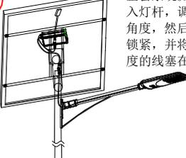
整套系统测试后，将套头套入灯杆，调整好电池板采光角度，然后将6颗螺丝对称锁紧，并将漏在外面多余长度的线塞在套筒内。
