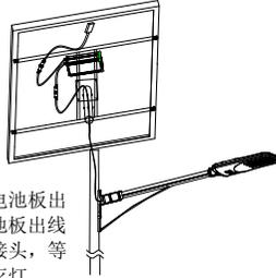
待光源亮灯后，将电池板出线和锂电池上的电池板出线相接，并拧紧防水接头，等待进入充电模式后关灯。
