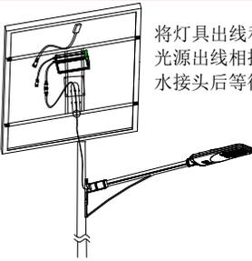
将灯具出线和电池上的光源出线相接，拧紧防水接头后等待光源亮灯。
