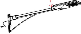
将灯具套在支臂上，并将灯具引出线穿出，调整好灯具角度之后锁紧灯具上的固定螺丝。
