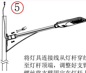
将灯具连接线从灯杆穿孔穿出至灯杆顶端，调整好支臂后用螺丝将支臂固定在灯杆上。
