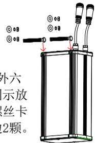
将M6\*35的外六角螺栓按图示放入一体机螺丝卡槽内，一边2颗。
