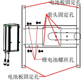
将上好螺丝的一体机按电池板支架上的安装孔位放入，并在支架的另一端依次放入平、弹垫、螺帽，然后锁紧。
